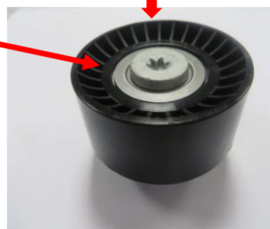
Jedna podkładka montowana od strony łba śruby
