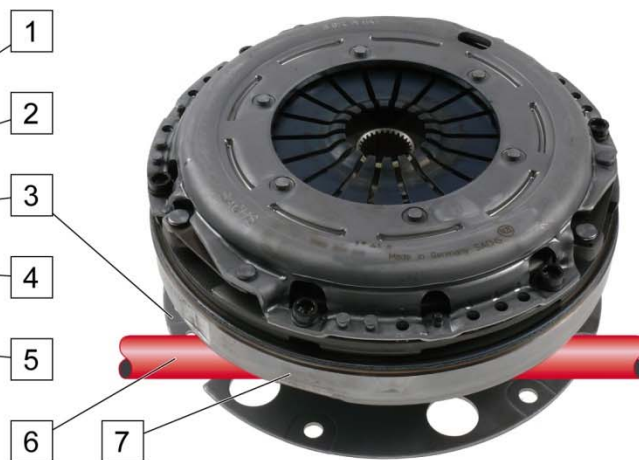
Ilustr. 2: Sprzęgło, dwumasowe koło zamachowe (7) i wał napędowy (6)
